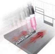
Umožňuje dosáhnout vyššího průvaru základního materiálu a zvýšení výkonu při zachování neméně průměrné hodnoty proudu.
